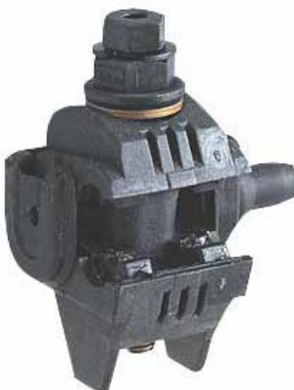
Слика 7.3.3.16.4 – Спојница за одвајање жила НН СКС за вод прикључка са жила НН СКС за главни вод са пробијањем изолације и истовременим спајањем
