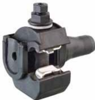
Слика 7.3.3.16.1 – Спојница за одвајање жиле НН СКС за главни вод са голог проводника од алучелика са пробијањем изолације жиле НН СКС за главни вод и истовременим спајањем
