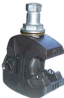
Слика 7.3.3.16.6 – Спојница за одвајање жила прикључка јавног осветљења са жила НН СКС за главни вод са пробијањем изолације и истовременим спајањем
