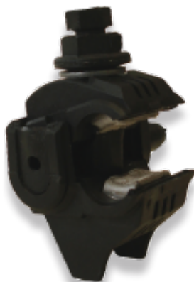
Слика 7.3.3.16.2 – Спојница за одвајање жиле НН СКС за вод прикључка са голог проводника од алучелика са пробијањем изолације жиле НН СКС за вод прикључка и истовременим спајањем
